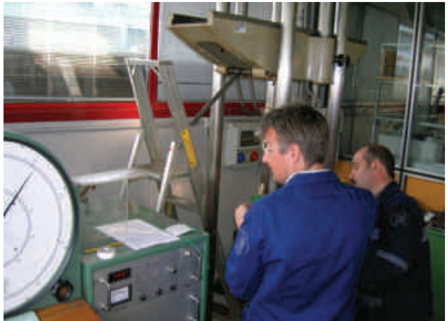
Tecnici del laboratorio LATIF - PAT nel corso di una prova di trazione
